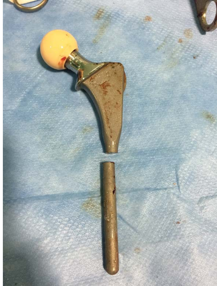
Fig. 1. Rotura vástago femoral de PTC no cementada. Tipo Furlong. A): Radiografía simple de pelvis. Proyección anteroposterior. B) Imagen del implante extraído.
